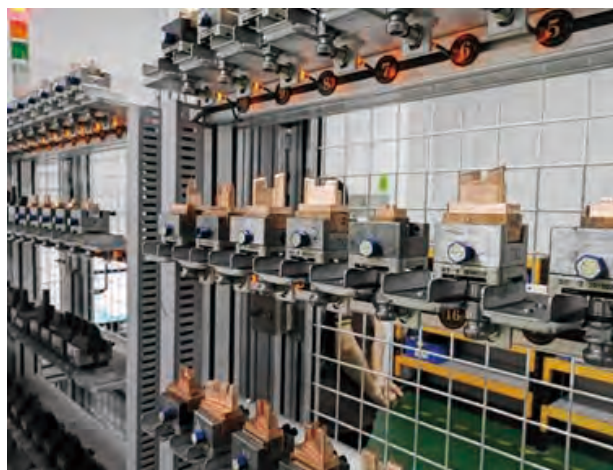
東江 - 銅工電極自動化測量
