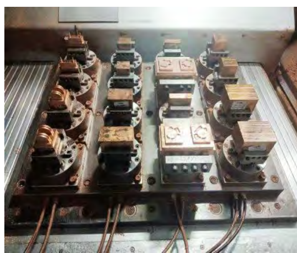
健大 - 多銅工電極 CNC 加工
