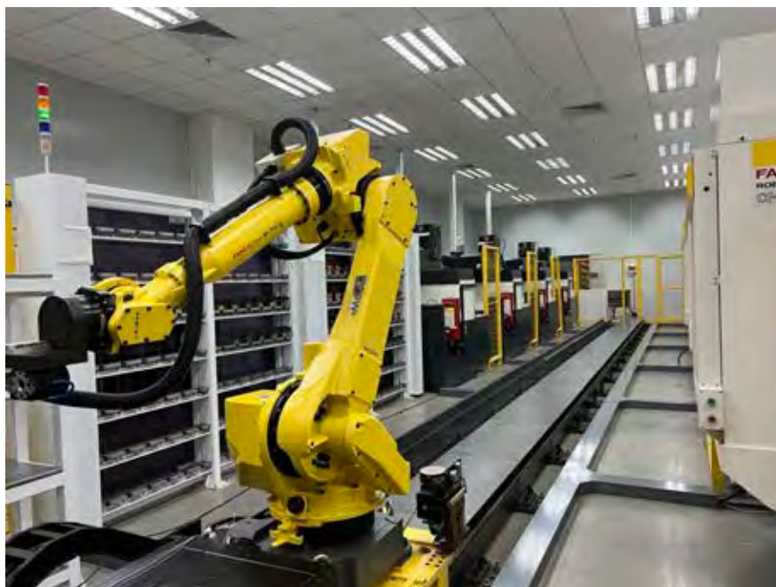
力嘉 - 多加工中心自動化，結合 CNC 與火花機自動化
