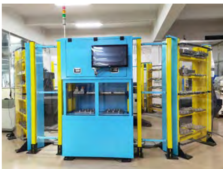
信興 - 電極三坐標測量自動化
