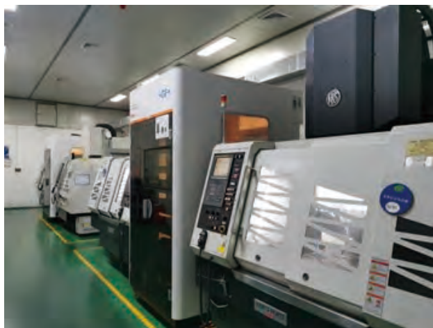
石墨電極自動化加工及自動化測量單元
