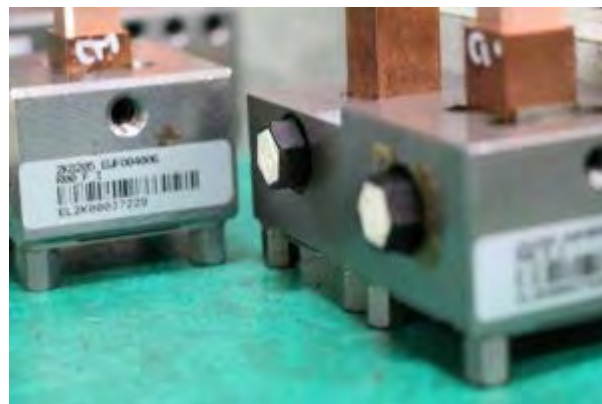
信興 - 電極條形碼系統與電極自動化所使用的 RFID 系統
